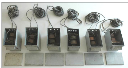
Fig. 6- Elementos constituintes da instalação: transformadores
