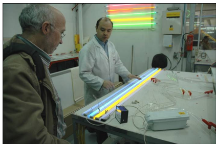
Fig. 10- António Quadros Ferreira (esquerda) e o técnico da Neolux durante os testes preliminares para verificar o estado de conservação das lâmpadas originais
