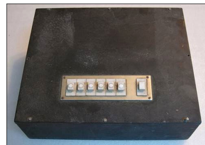
Fig. 8- Elementos constituintes da instalação: programador
